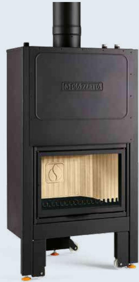
› Monoblocco in acciaio verniciato di notevole spessore con focolare chiuso. Focolare in **Aluker®**. Braciere con piano di fuoco in **ghisa**, griglia in ghisa e paralegna. Pulizia dello scambiatore manuale. Vaso di espansione optional. Sistema ACS, per acqua ad uso sanitario optional. Porta e profilo porta in acciaio verniciato. Maniglia in acciaio verniciato con manofredda. Apertura a saliscendi e ad anta per la pulizia. Cappa in acciaio.
