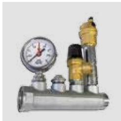
› Composto da: **valvola sicurezza** 2 bar, **manometro**, **valvola automatica sfiato aria**, raccorderia per il collegamento al monoblocco. Il kit è necessario per soddisfare i requisiti di sicurezza nel caso di installazione a vaso chiuso.
