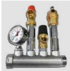
› Composto da: **valvola di scarico termico** 90° C / 3 bar, **valvola sicurezza** 1,5 bar, **manometro**, **valvola automatica sfiato aria** e relativi raccordi per il collegamento al monoblocco. Il kit è necessario per soddisfare i requisiti di sicurezza nel caso di installazione a vaso aperto.
